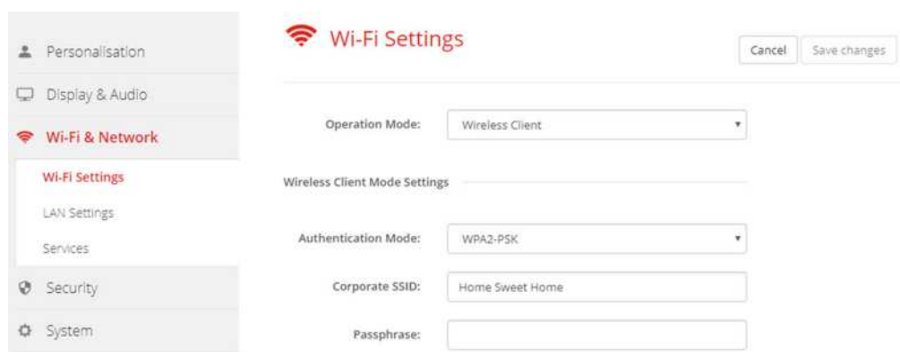
Obrázek 6-26: Nastavení sítě Wi-Fi, bezdrátový klient, WPA2-PSK
