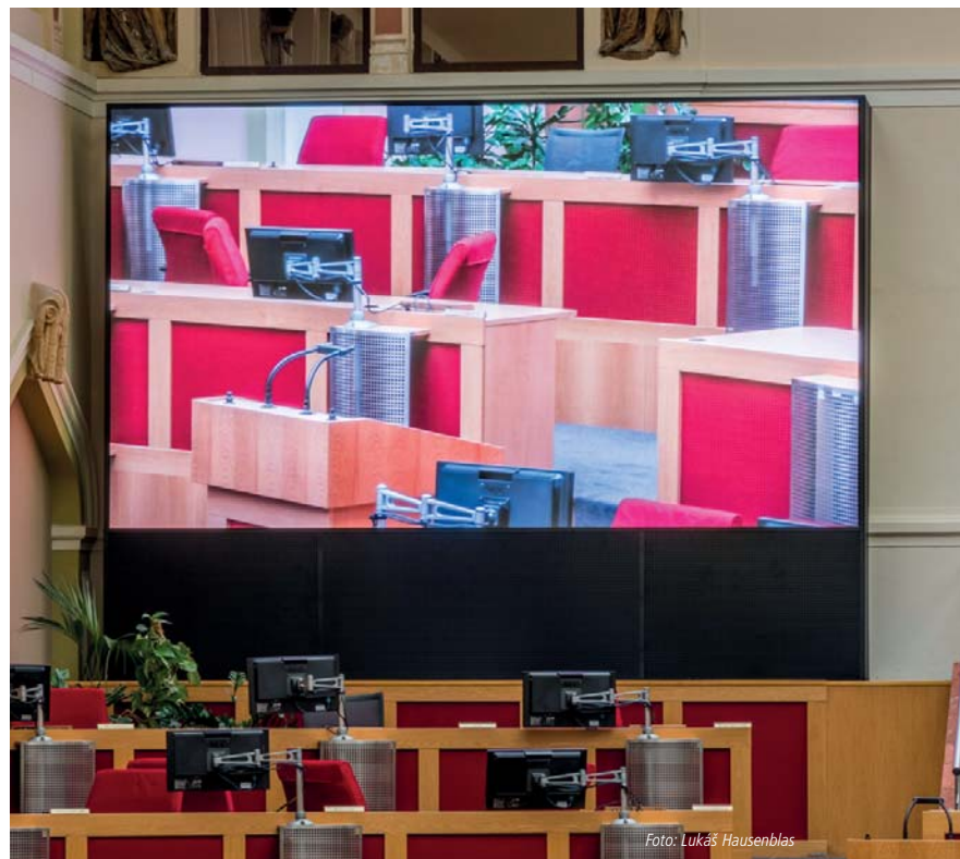
LED obrazovka Konka s roztečí diod 2,5 mm.
