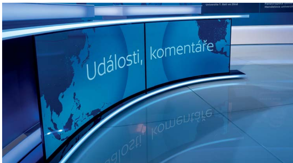
Detail zakřivených LG open frame panelů.
