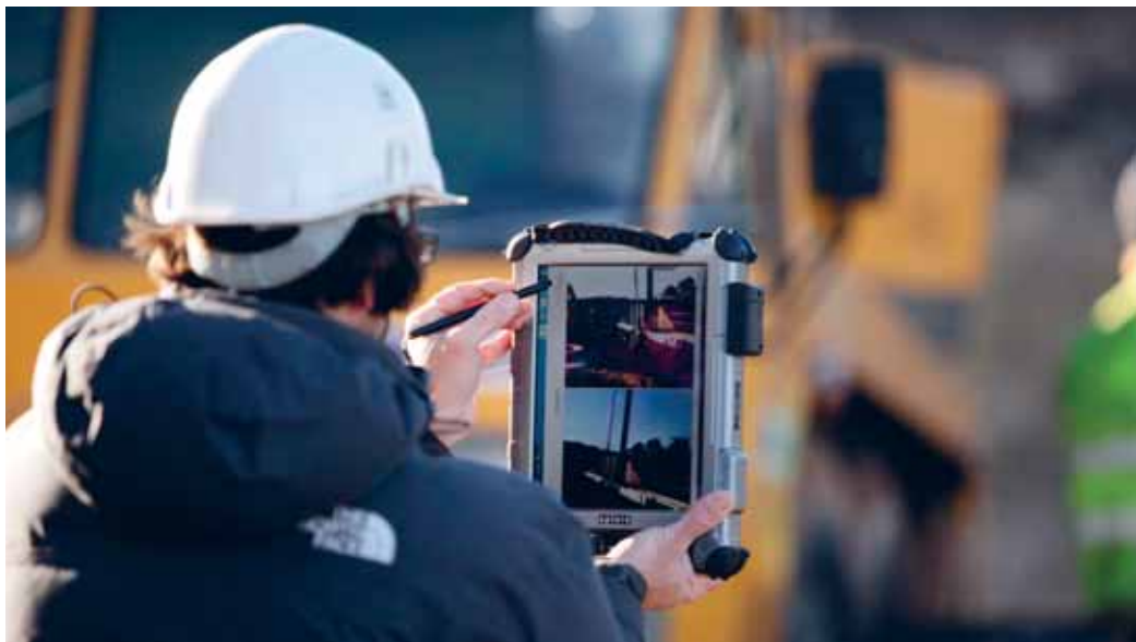
Modelu Xplore iX104 nechýba 3 Mpix kamera na zhotovovanie snímok v extrémnych podmienkach. Všimnite si na pravej hrane samostatný modul GPS s garanciou presnosti lokácie do jedného metra.
