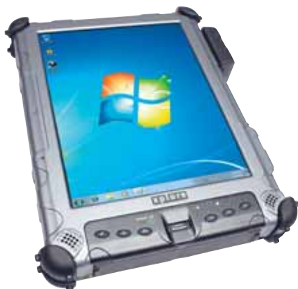
Biometrický snímač je základom bezpečnosti údajov v tablete. Prevádzková teplota je od -20 °C vyššie.
